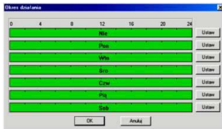
Rys. 7-38a. Ustawianie okresu aktywności wejścia alarmowego.
