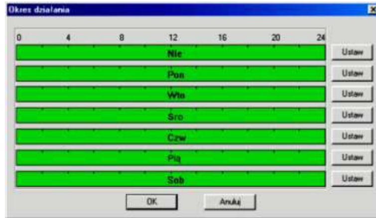
Rys. 7-41a. Ustawianie okresu aktywności wejścia alarmowego.
